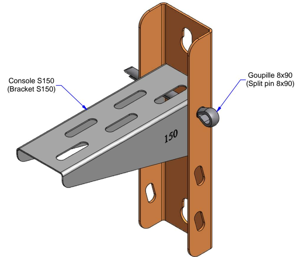
**SZ** : Tôle d'acier galvanisé avant fabrication suivant NF EN 10346 (S220 GD / Z).
